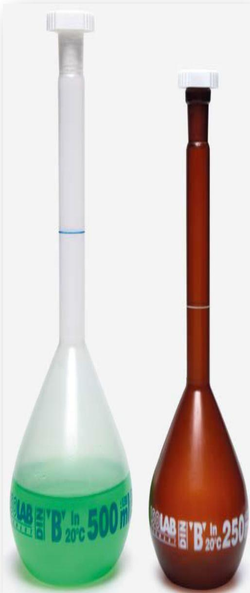
➤ Fabricado de polipropileno según la norma DIN EN ISO 1042. Presenta alta transparencia y alta resistencia química y de la cabeza.
